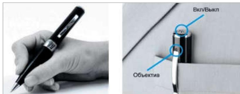
**Рис. 20. Система скрытой видеозаписи на базе цифрового видеорекодера, встроенная в авторучку.**
