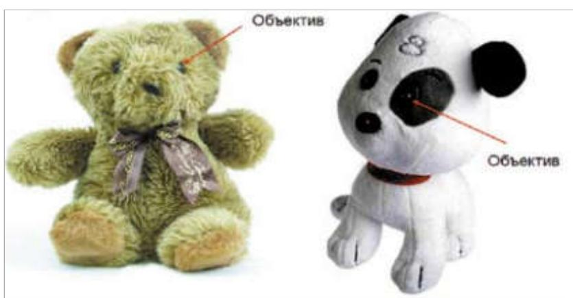
Рис. 29. Портативные телевизионные передатчики, закамуфлированные под мягкие игрушки.
