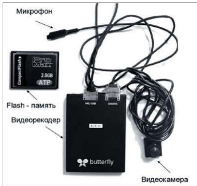
**Рис. 10. Портативная цифровая система видеозаписи на базе цифрового видеорекодера Butterfly.**
