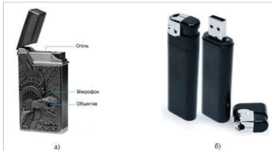
**Рис. 14. Система скрытой видеозаписи на базе цифрового видеорекодера, встроенная в зажигалку.**
