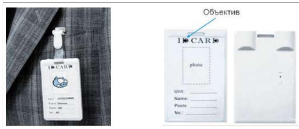
**Рис. 17. Система скрытой видеозаписи на базе цифрового видеорекодера, встроенная в ID - карту.**
