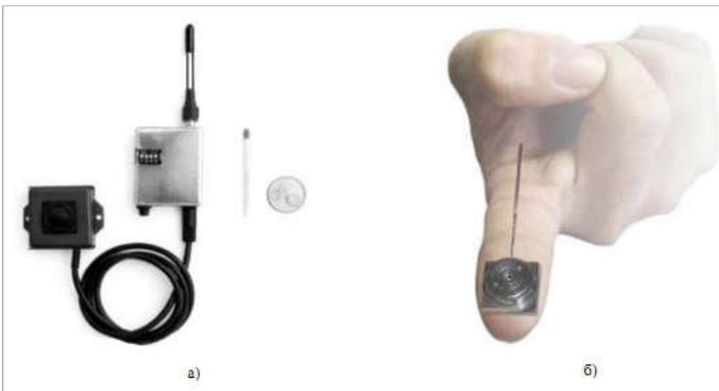
**Рис. 24. Миниатюрные видеопередатчики.**
