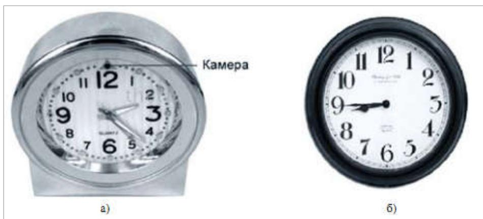
Рис. 12. Система скрытой видеозаписи на базе цифрового видеорекодера, встроенная в настольные (а) и настенные (б) часы.
