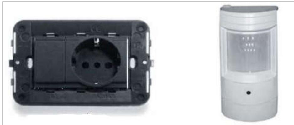
**Рис. 8. Видеокамеры «pin-hole», встроенные в электрическую розетку (а) и пассивный инфракрасный датчик (б).**
