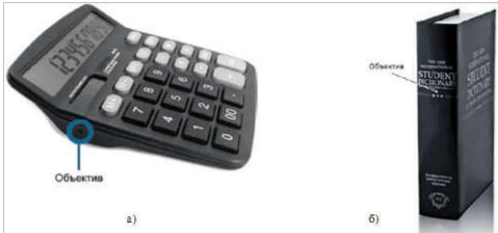
Рис. 13. Система скрытой видеозаписи на базе цифрового видеорекодера, встроенная в калькулятор (а) и книгу (б).
