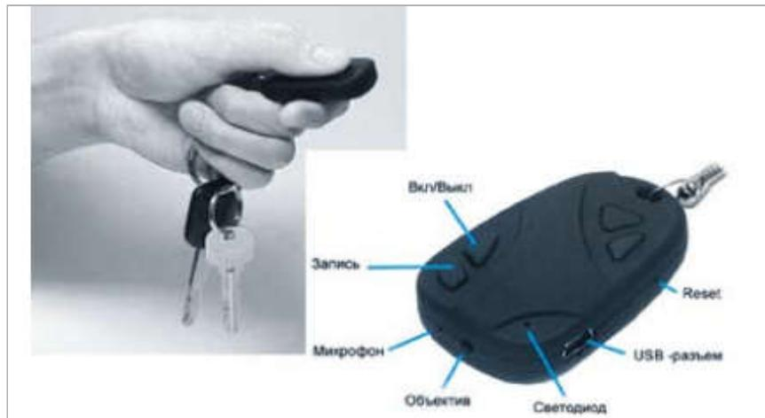
**Рис. 18. Система скрытой видеозаписи на базе цифрового видеорекодера, встроенная в брелок.**
