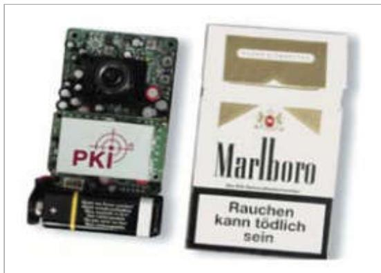
**Рис. 26. Миниатюрный видеопередатчик PKI5700, закамуфлированный под пачку сигарет.**
