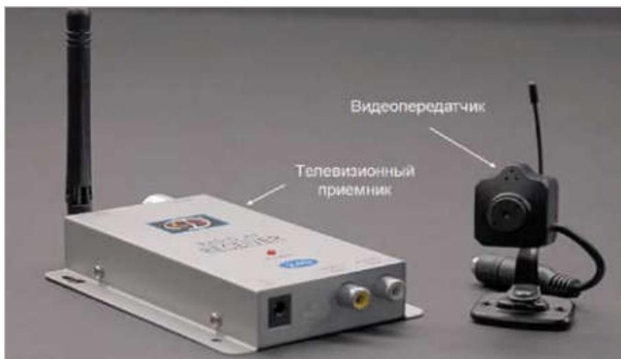
**Рис. 32. Система скрытого видеонаблюдения с передачей информации по радиоканалу.**
