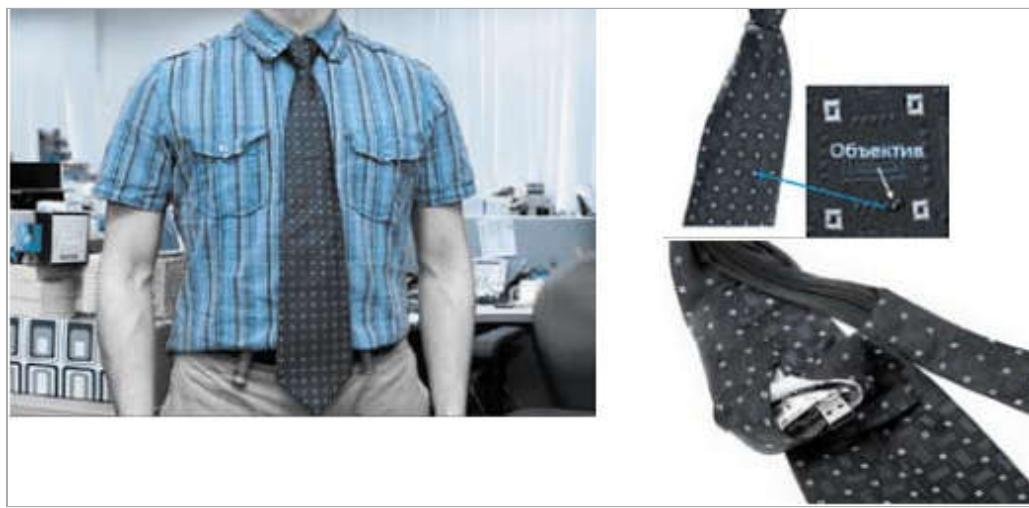
**Рис. 19. Система скрытой видеозаписи на базе цифрового видеорекодера, встроенная в галстук**
