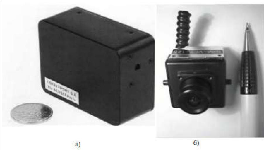
**Рис. 25. Миниатюрные видеокамеры, комплексированные с видеопередатчиками: а) SIM-VLT-241/IA; б) SIM-VLT-125.**
