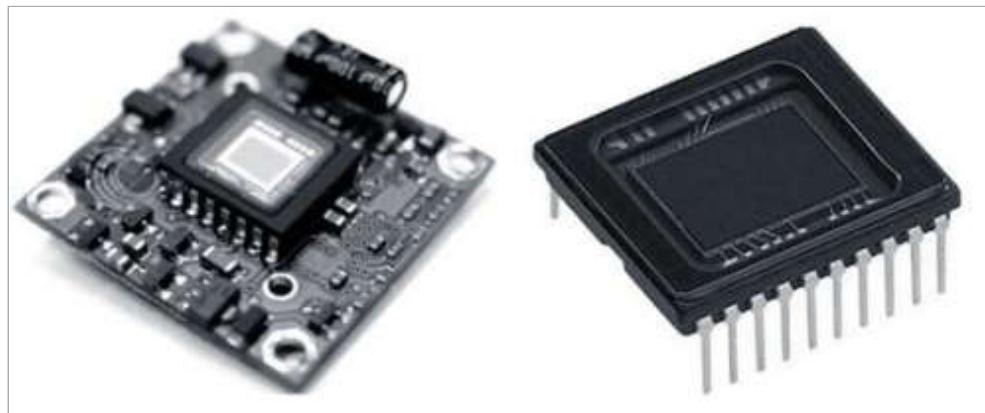
**Рис. 3. Внешний вид миниатюрных матриц ПЗС, используемых в системах скрытого видеонаблюдения.**
